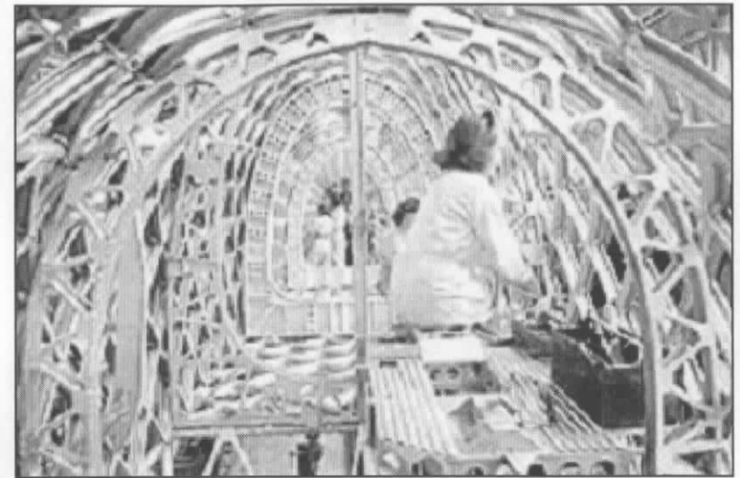
Wellington in opbouw: zicht van voor naar achteren in de romp
